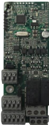
IO expansion card EC-IO501-00
